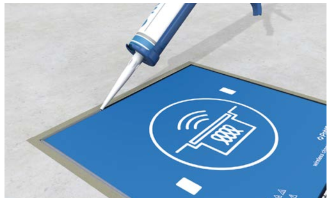
Um zu verhindern, dass Wasser oder Schmutz in die Kassette eindringen kann, Dichtungsmasse in die Fuge zwischen PCX-Deckel und Kassettenrand einbringen.
